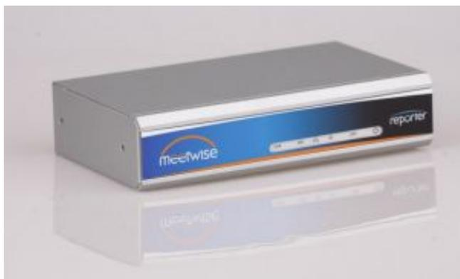
meetwise reporter LT - 1HE Einbauvariante Durch seine Ausführung als externe Hardware ermöglicht der reporter den remote Zugriff auf Rechner ohne Netzwerkanschluss oder die Übertragung von Bildschirmhalten in geschlossenen Netzwerken (Industrie-, Produktionsnetzwerk).
