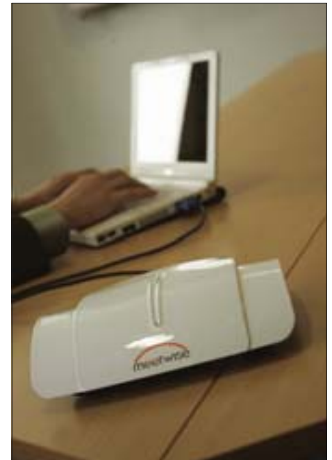
Der Meetwise Reporter ist ein KVM over IP Extender mit Web-Dienst und Daten-Proxy und vereinfacht das Dokumenten-Sharing während Telekonferenzen.
